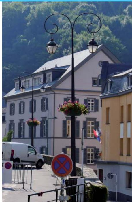
Im Bereich des Place du Marchée sind die dekorativen Mastleuchten in gleicher Bauform und gleichem Leuchtendesign eingebaut wie im unterhalb gelegenen Stadtzentrum. Die Masthöhe und die Montagehöhe der Leuchten ist jedoch größer / höher. Die Lichtpunkthöhe beträgt etwa 6,50m, die Gesamthöhe der Leuchte etwa 7,50m.
