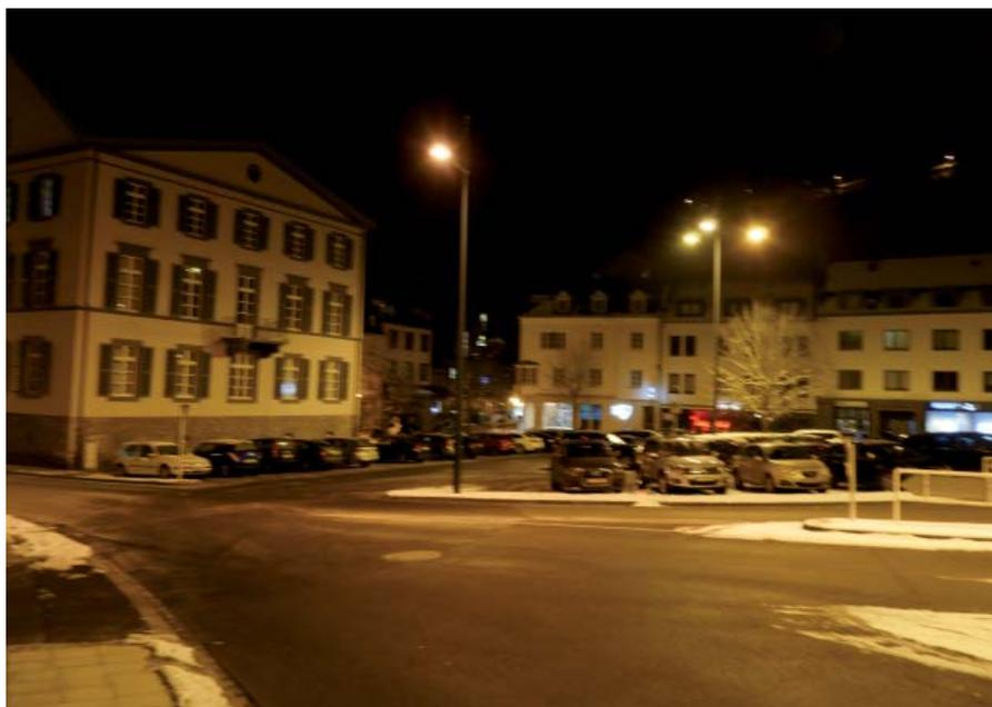
Im Nachtbild von Clervaux/Clerf wird deutlich, dass zwei unterschiedliche Lichtfarben eingesetzt werden. Gelblastiges Licht für die Funktionalbeleuchtung, warmweißes Licht für die Akzentbeleuchtung (Anstrahlung der Architekturen).
