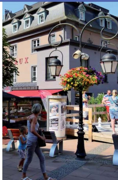
In der Fußgängerzone und auf dem zentralen Platz an der Grand Rue sind dekorative Mastleuchten in einfacher und doppelter Ausführung eingesetzt. Die Leuchtenkörper sind an einem Ausleger mit ornamentaler Ausgestaltung aufgehängt. Die eingesetzten Gläser sind opal ausgeführt. Die Lichtpunkthöhe beträgt etwa 3,50m, die Gesamthöhe der Leuchte etwa 4,50m.
